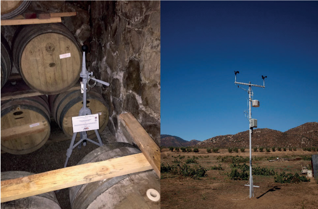
Figura 3. Izquierda: Sensores para mediciones de TBS, HR y TGN y derecha: Estación meteorológica. Fuente: Fotos del autor (2017).
